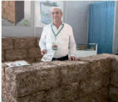
**VUELTA AL ADOBE.** El constructor riojano Manuel Rodríguez Barriobero propone bloques aligerados de tierra y paja para una bioconstrucción sostenible. Su aislamiento térmico y su flexibilidad ante movimientos sísmicos son dos de sus cualidades destacadas. [JAVIER DE LA FUENTE]
