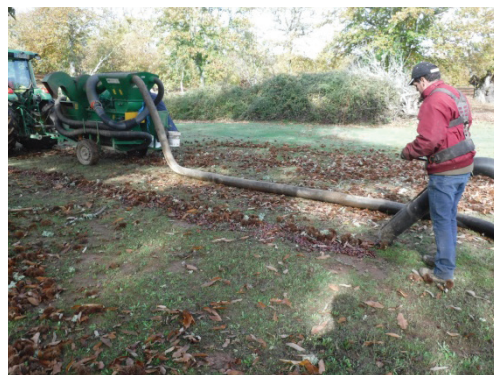
Figuras 12.4 e/y 12.5 – Colhedor por vácuo rebocado em trabalho. Recogedor mediante aspiración remolcado por tractor.
