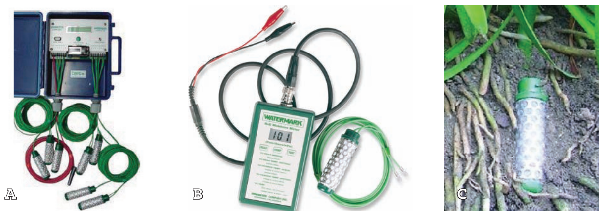
Figura 9.3 – Dispositivos de leitura e armazenamento de dados ( A e B ) de sensor de matriz granular (WaterMark) com eletrodos envolvidos em quartzo e gesso ( C ). Fonte: http://www.irrometer.com
